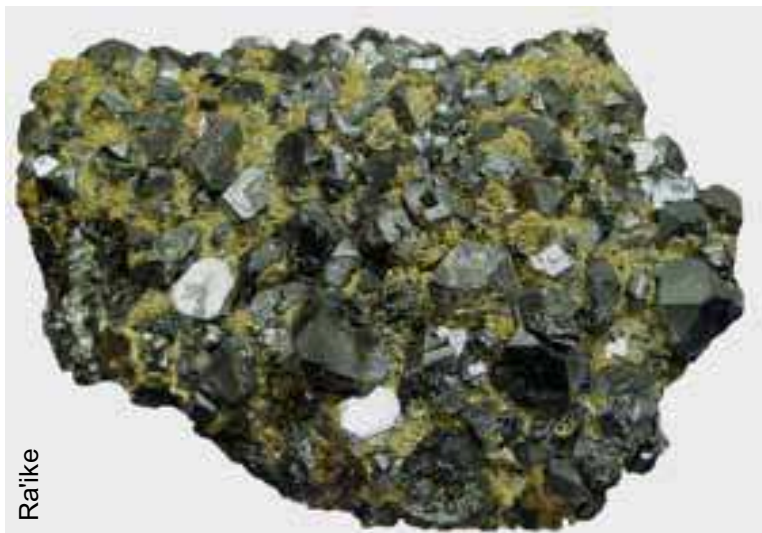
Galénite Combinaison naturelle du plomb et du soufre ; elle est le principal minerai de plomb avec une teneur qui peut atteindre 87%.
